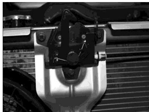
➤ کابل درب موتور باز نمایید و بدنه قفل را از درب موتور جدا نمایید.
